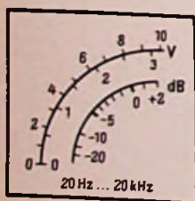
Bild 16. Die Skala des Mustergeräts (vereinfacht); Richtlinien für die Teilungen siehe Tabelle 2
