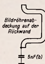
Bild 5. Kapazitive Erdung der Bildröhrenabdeckung
